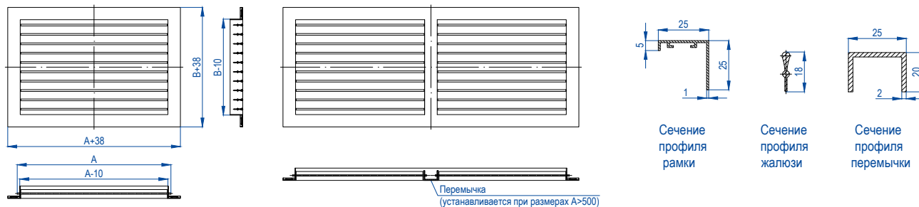
Профили, используемые при изготовлении решеток
